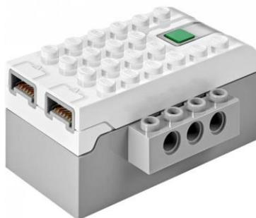
Nos permitirá conectar los motores y sensores para poder programarlos, tiene dos entradas que nos permitirá conectar motores y sensores, dichas entradas nos permiten conectar sensores y motores indistintamente.
